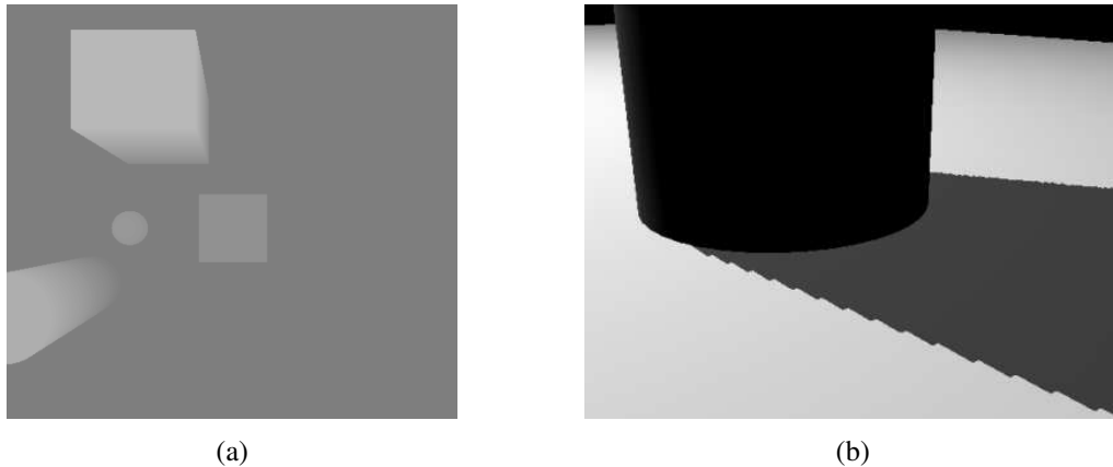
Abbildung 2.4: (a) Eine Shadow Map mit Tiefeninformationen aus Sicht der Lichtquelle, (b) Aliasing bei Shadow Mapping [8].
